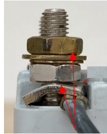
規定締付トルク Specified Tightening Torque
